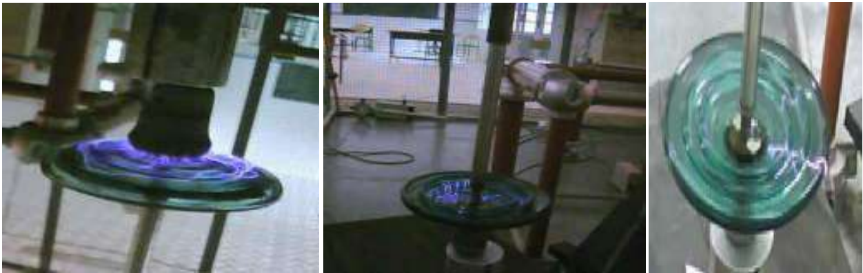
Figure 3.7 : processus de contournement observé en laboratoire
