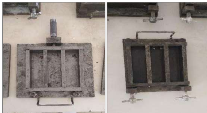
Photo II.16: Moules prismatiques utilisés 40 \times 40 \times 160 \text{ cm}^3 .
