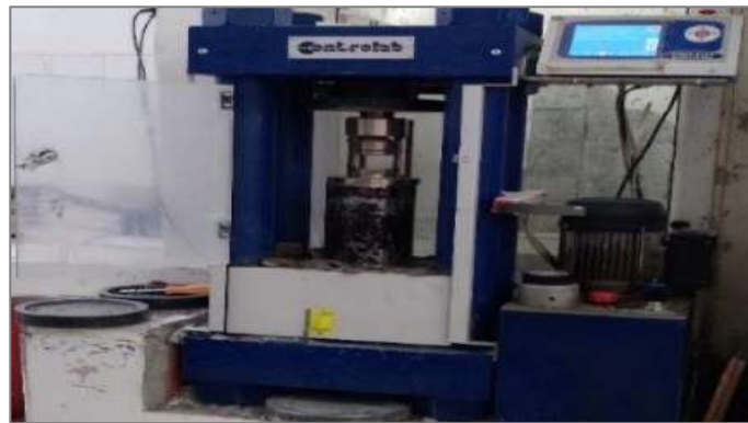
Photo II.14: Dispositif de rupture en compression.
