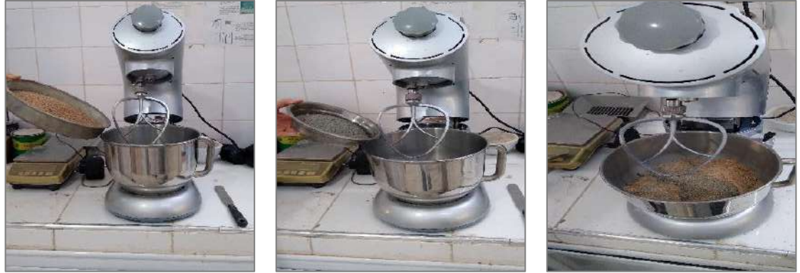
Photo II.18: L'ajout de sable et de ciment.
