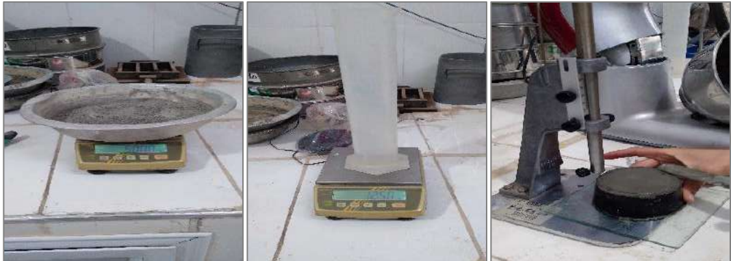
Photo II.7: Photos prises durant l'essai de détermination du temps de prise du ciment.
