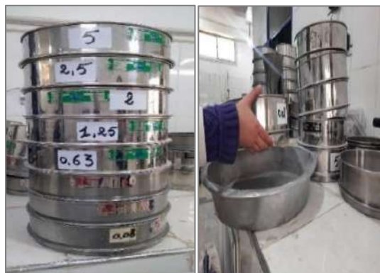
Photo II.3: Essai d'analyse granulométrique des sables.
