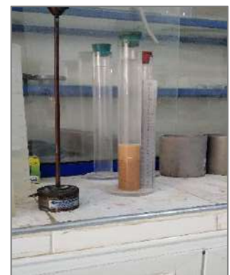
Photo II.4: Essai d'équivalent de sable.
