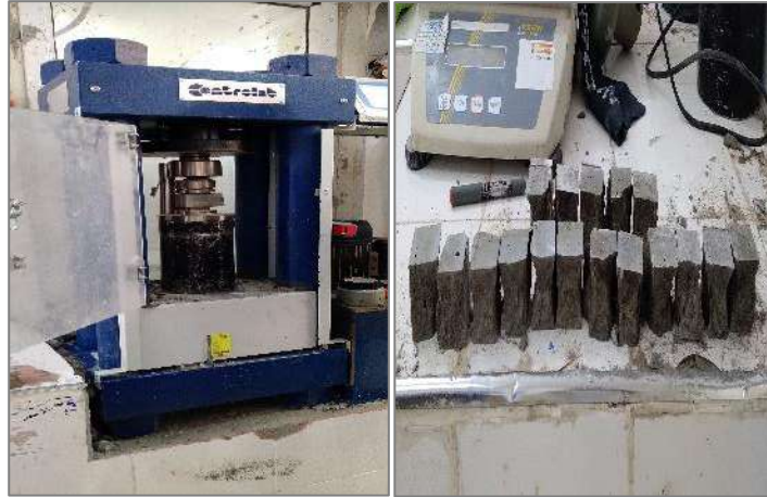
Photo II.21: Essai de détermination de la résistance à la compression.
