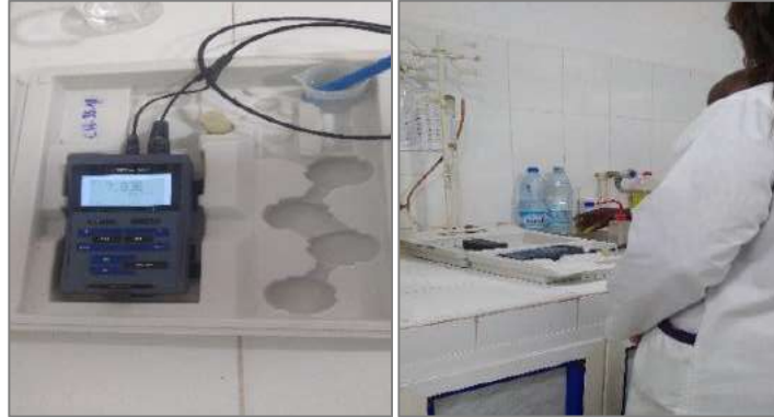
Photo II.8: Essai de détermination de PH d'eau utilisé.
