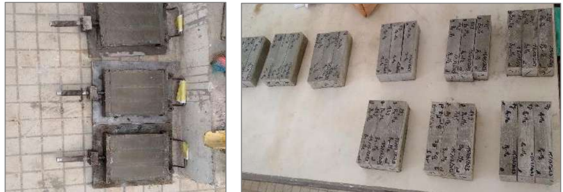
Photo II.20: La conservation des éprouvettes avant le démoulage et le démoulage des éprouvettes.
