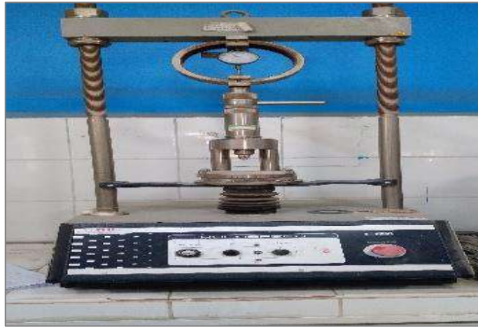
Photo II.15: Dispositif pour l'essai de résistance à la flexion (3 points).
