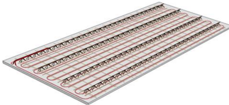
Figure II. 9 Dalle Actif: Prédalle.
