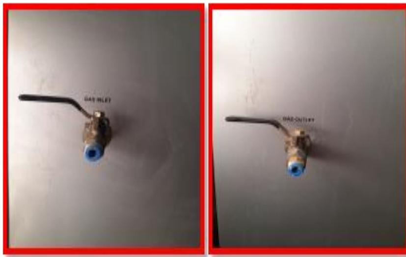
Figure (II-15) : Vanne de commande de gaz dans un appareil spray pyrolyse (entrée _ sortie)
