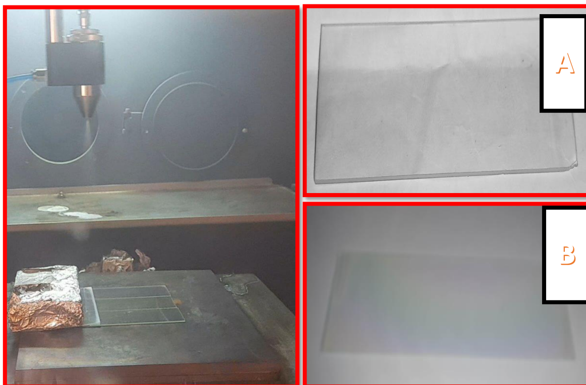
Figure III.5. Dépôt de couche mince (A Avant dépôt et B après dépôt)
