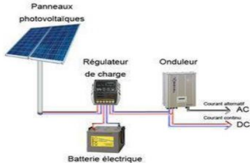
Figure II.6 : Système PV autonome
