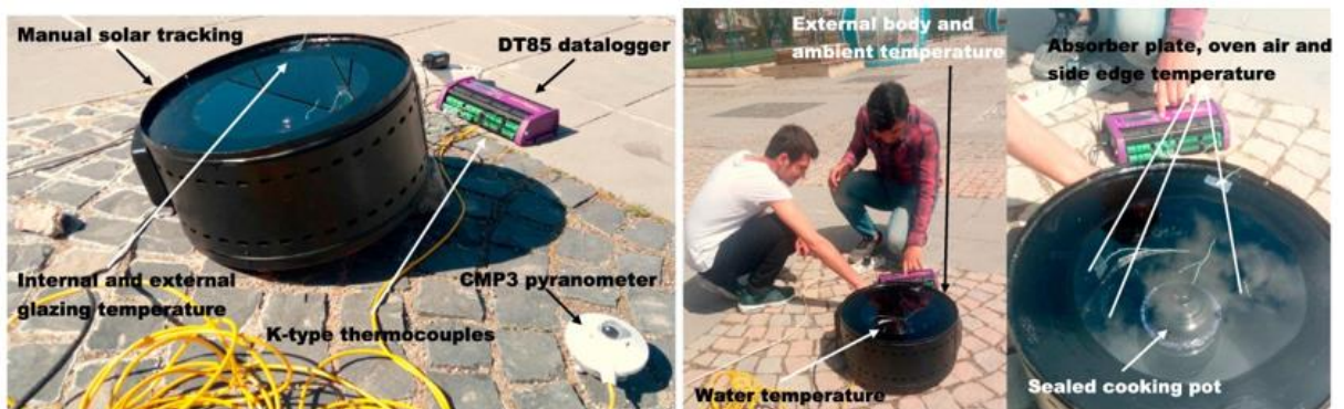
Fig. I.21: Analyse expérimentale illustrative du cuiseur solaire cylindrique avec les systèmes de mesure.
