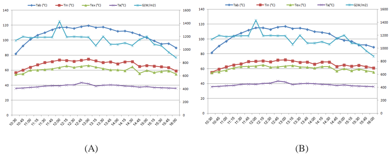
Fig. IV.4.1 évaluation Thermique de deux cuiseurs, au premier jour.
