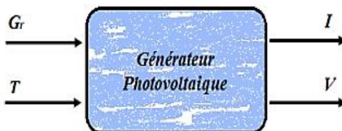
Figure II. 1 : Schéma bloc de générateur photovoltaïque.
