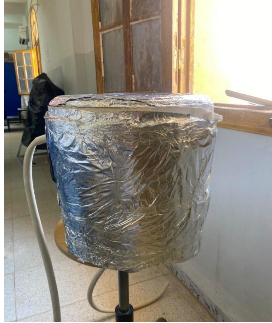
الشكل (4-5) : خزان الرمال المعزول
