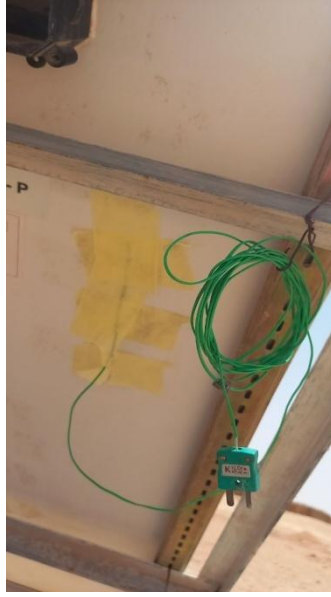
الشكل (10.III): تثبيت Thermocouple على الجهة الخلفية للألواح الشمسية
