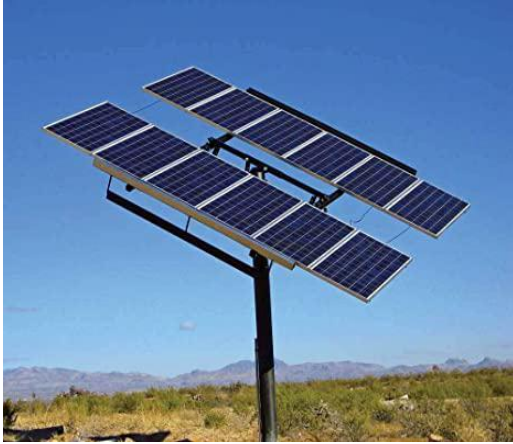
الشكل (3.II): متتبع شمسي بآلية التحكم السلبي
