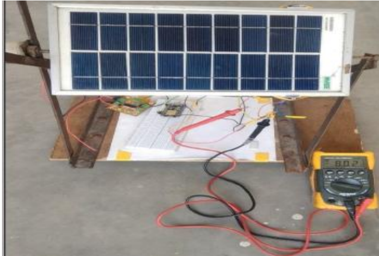
الشكل (II. 2): متتبع شمسي بآلية التحكم الإيجابي (النشط)
