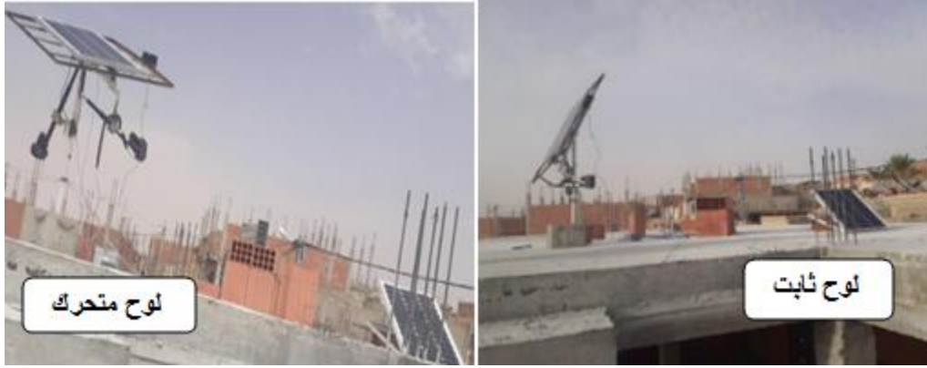
الشكل (1.III) : اللوح الثابت مع المتتبع الشمسي ثنائي المحور في وضعيات مختلفة
