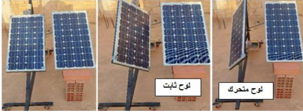
الشكل (2.III): اللوح الثابت مع المتتبع الشمسي أحادي المحور في وضعيات مختلفة
