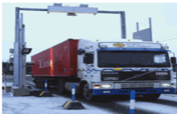
FIGURE 1.13 – RFID contrôle d'accès.
