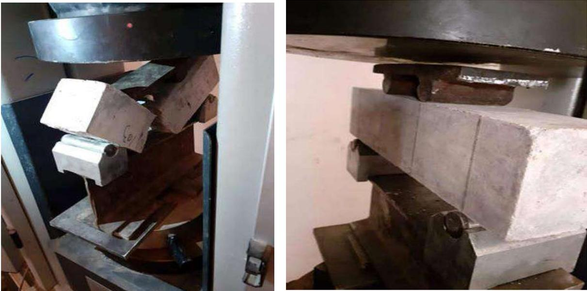
Photo III-2 : essai de flexion par traction
