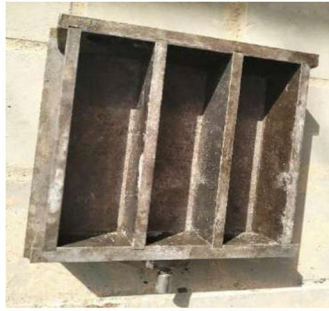
photo II.9 : Moule pour moulage des Mortier
