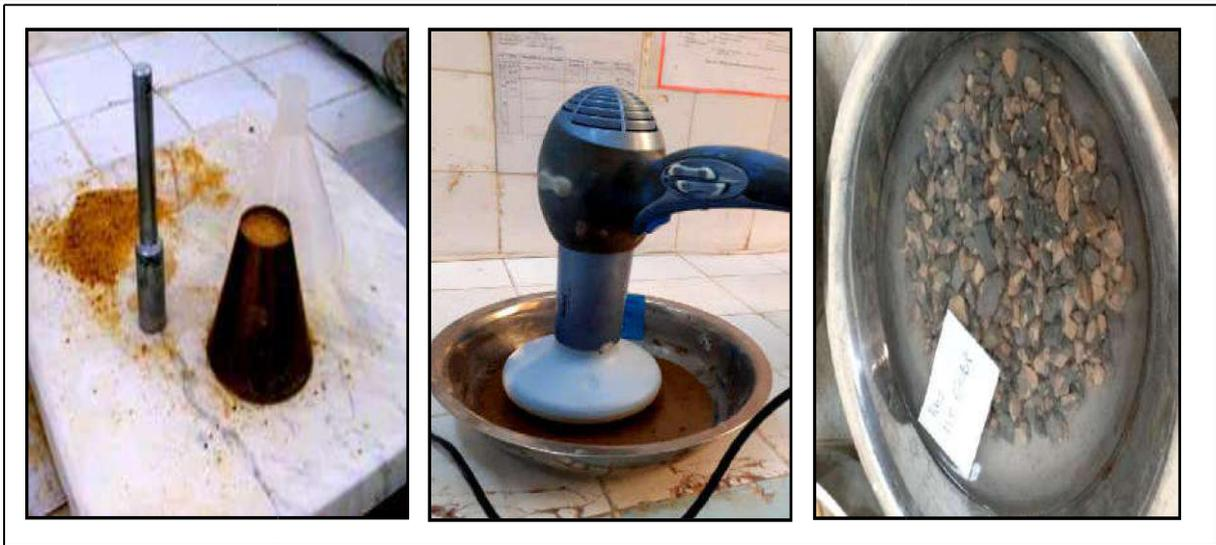
**Photo II.7 : essai d'absorption d'eau des différents matériaux**
