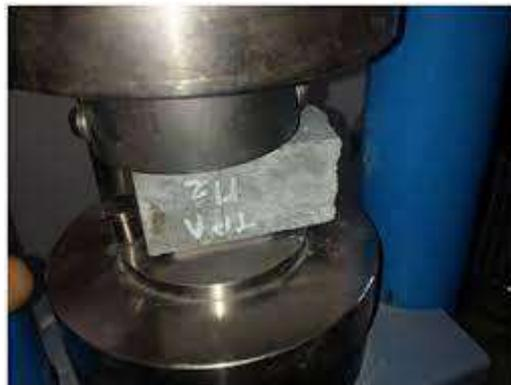
**Photo III-1 : essai de compression**
