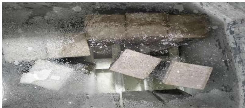
**Photo II.12 : Conservation des éprouvettes dans l'eau**
