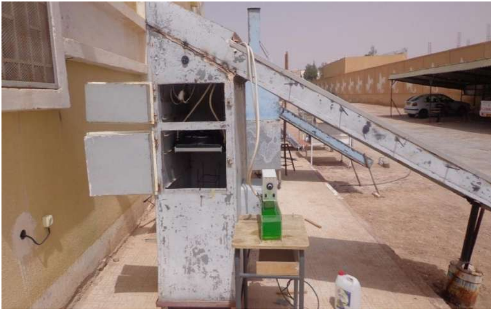
Figure B1 : Intégration d'un échangeur air-eau dans la chambre de séchoir solaire indirect
