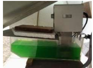
Figure B1 : Intégration d'un échangeur air-eau dans la chambre de séchoir solaire indirect
