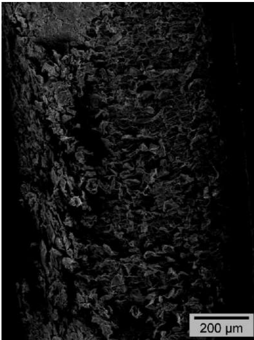
Figure III.2 : Vue microscopique longitudinale typique des FSPD au MEB ( KRIKER.,2005)
