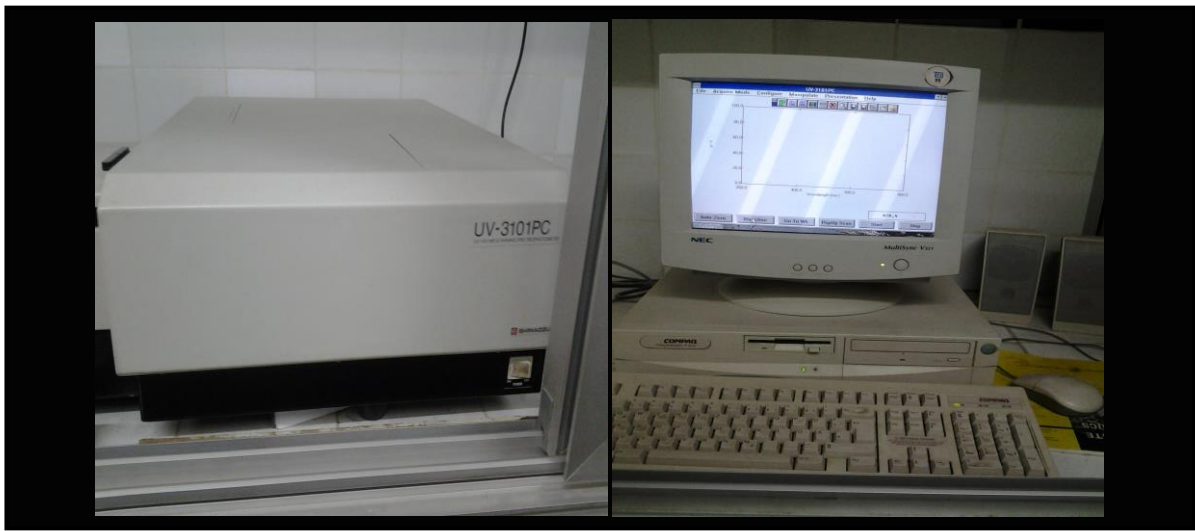
Figure (II-6): Dispositif expérimental de la spectroscopie UV-visible (UV3101PC type Shimadzu). [Laboratoire des Couches Minces, Université des Frères Mentouri de Constantine]
