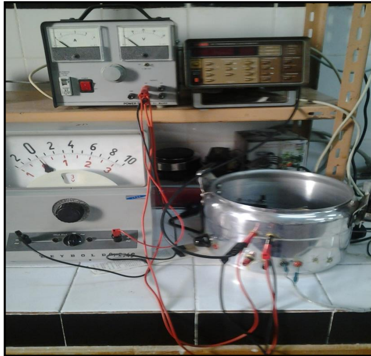
Figure (II-9): Dispositif expérimental de deux points (coplanaire). [Laboratoire des Couches Minces, Université des Frères Mentouri de Constantine]
