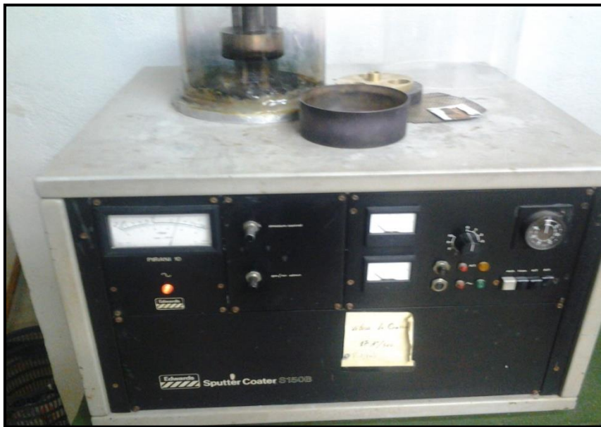
Figure (II-8): Dispositif expérimental de sputter coater S150B. [Laboratoire des Couches Minces, Université des frères Mentouri de Constantine]
