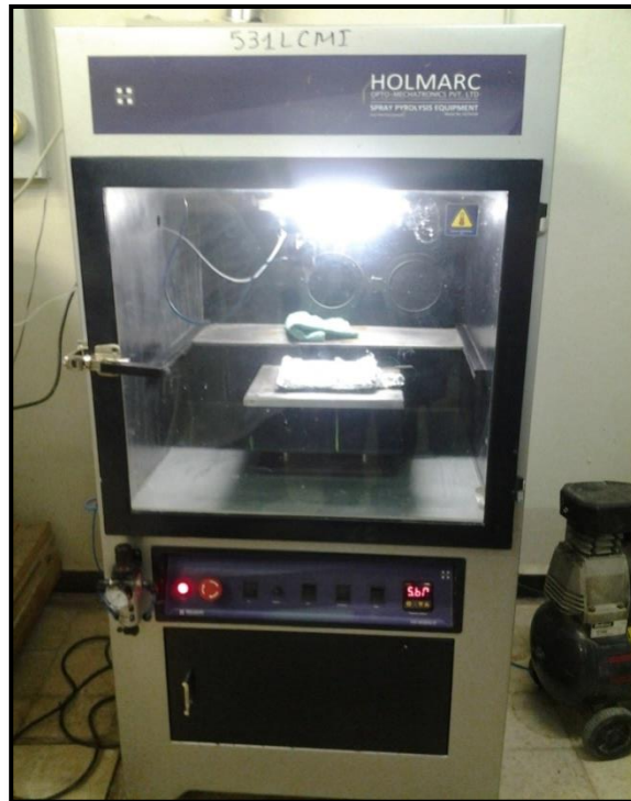
Figure (III-2): Dispositif expérimentale de spray pyrolyse. [Laboratoire des Couches Minces, Université des Frères Mentouri de Constantine]
