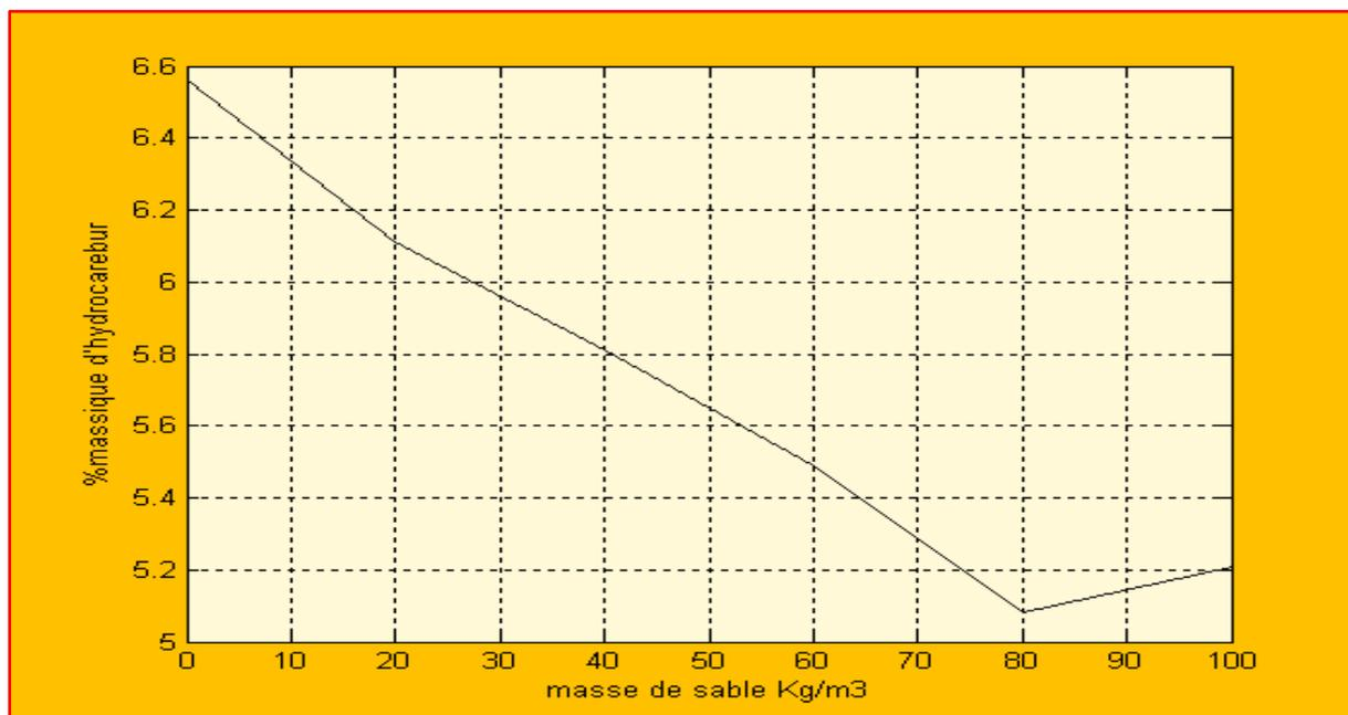
Figure (4.2) : Variation de la teneur en hydrocarbure en fonction de la concentration en sable.
