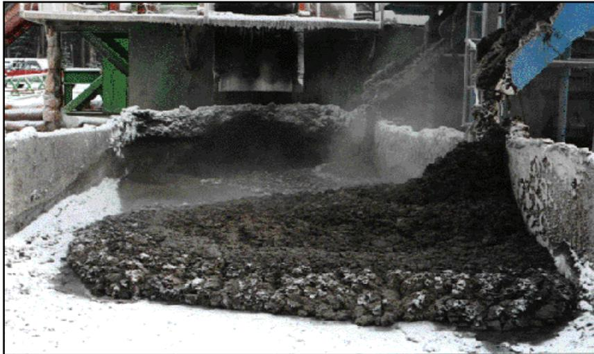
Photo(13) opération de décharge des déchets solides sèches (Dewatered).
