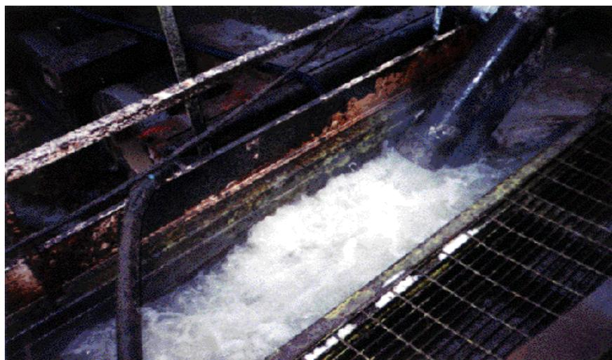
Photo(14) liquides retourne vers le système actif (système de boue de forage)
