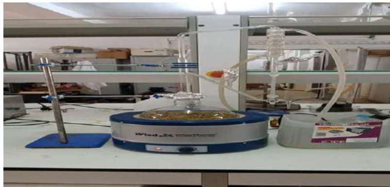
Figure 12 : Montage d'hydro distillation de type Clevenger
