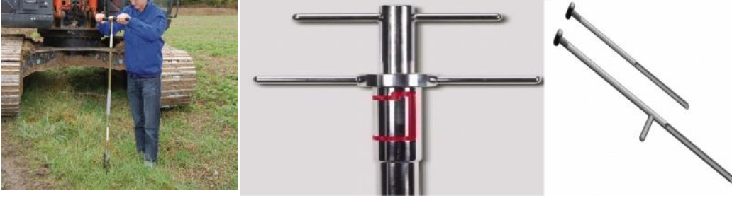
صورة لكيفية اخذ العينة من التربة أداة اخذ العينة
