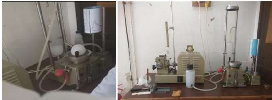
Figure 23 : appareille de détermination la qualité rhéologique de la pâte.
