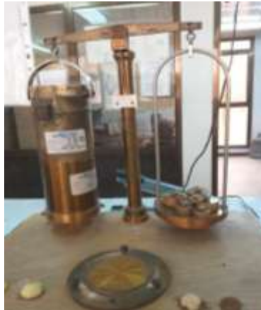
Figure 25 : Appareil de Nélima– litre.
