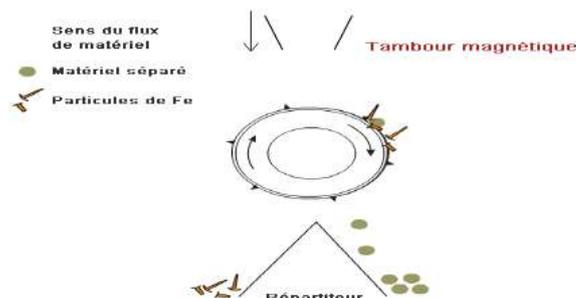
Figure 1.8 Fonctionnement de Séparateurs magnétiques à tambours
