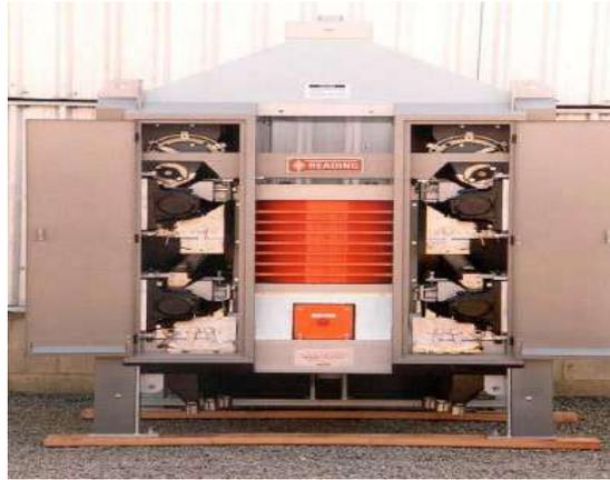
Figure 1.21 séparateur à rouleaux magnétiques induits
