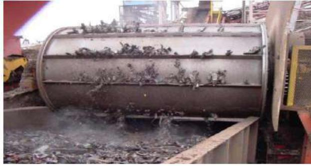
Figure 1.14 Fonctionnement d'un séparateur magnétique à tambour sec
