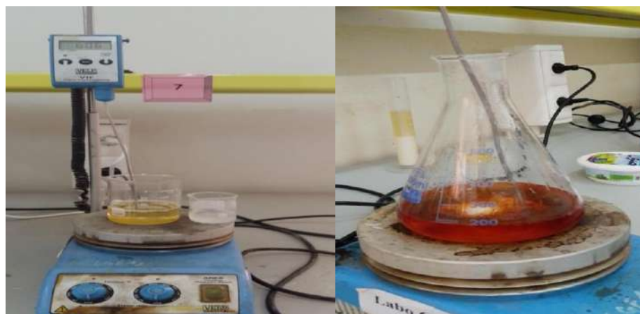
Figure. II 7 : Montage de la réaction de transestérification
