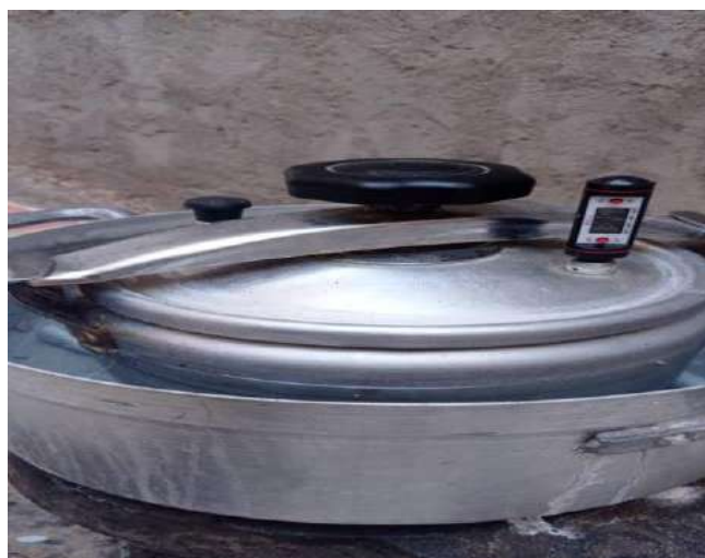
Figure II .1 : Montage d'extraction de graisse de chameau
