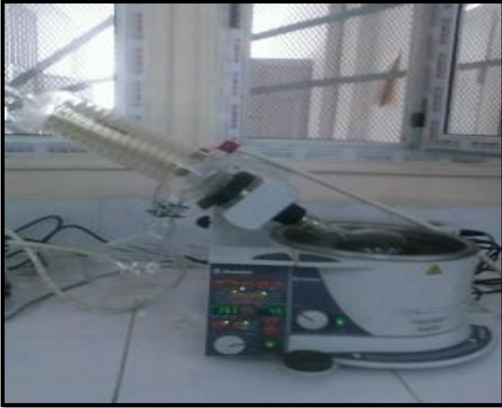
الشكل رقم (3): جهاز التبخير والتقطير الدوراني ( Rota vapeur )
