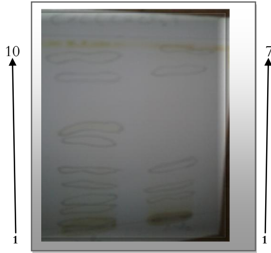
الشكل (3-IV) اكروماتوغرام الطبقة الرقيقة للمستخلص الكلوروفورم
