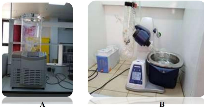
Figure 08 : Photos de matériels utilisés. A : lyophilisateur B évaporateur rotatif
