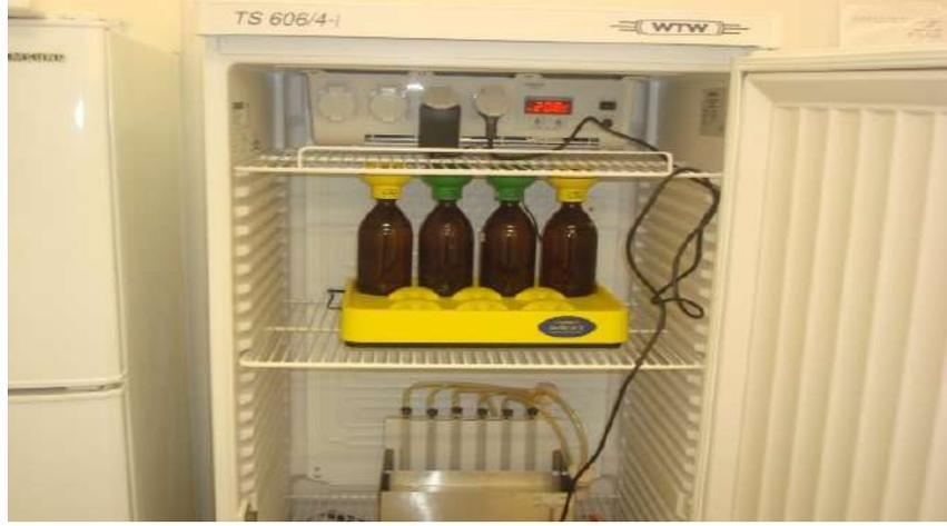
شكل 8.4: اجزة قياس الطلب الحيوي على الأوكسجين (DBO5)
