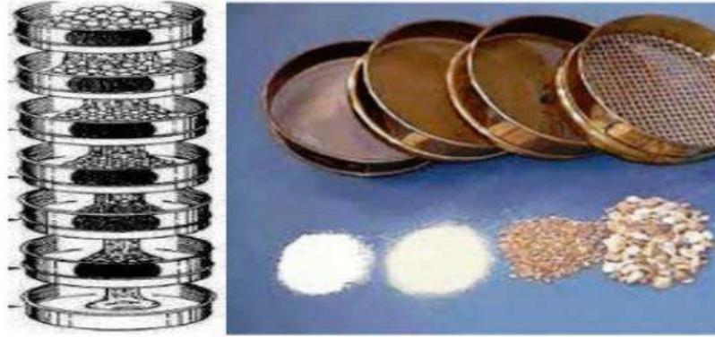
شكل 1.2: الشكل مجموعة المناخل المستخدمة في تحديد أقطار الرمال المطلوبة بتقنية التحليل بالمناخل
