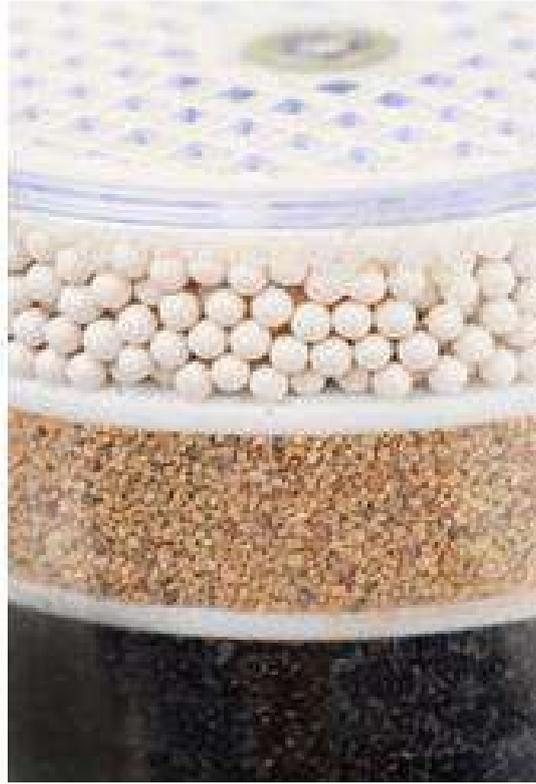
شكل 4.2: شكل خليط أوساط الترشيح في المرشحات
