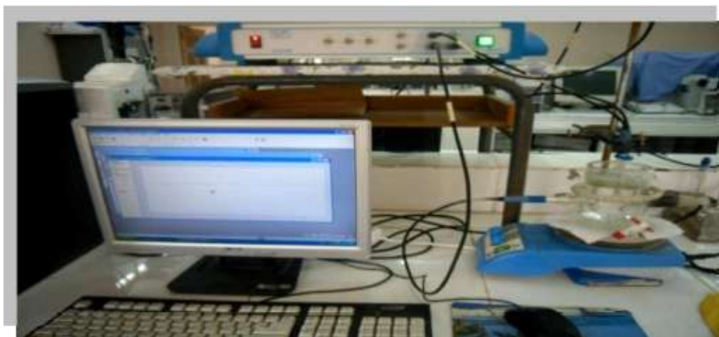
الشكل-1-V- الجهاز التجريبي للطريقة الإلكتروكيميائية
