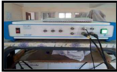
الشكل (III-3) : جهاز Galvanostat-Potentiostat من نوع PGZ301.
