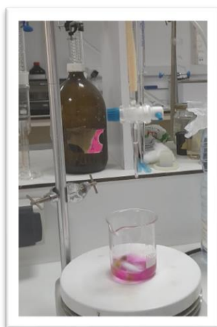
Figure 7 : Titration de l'acidité.
