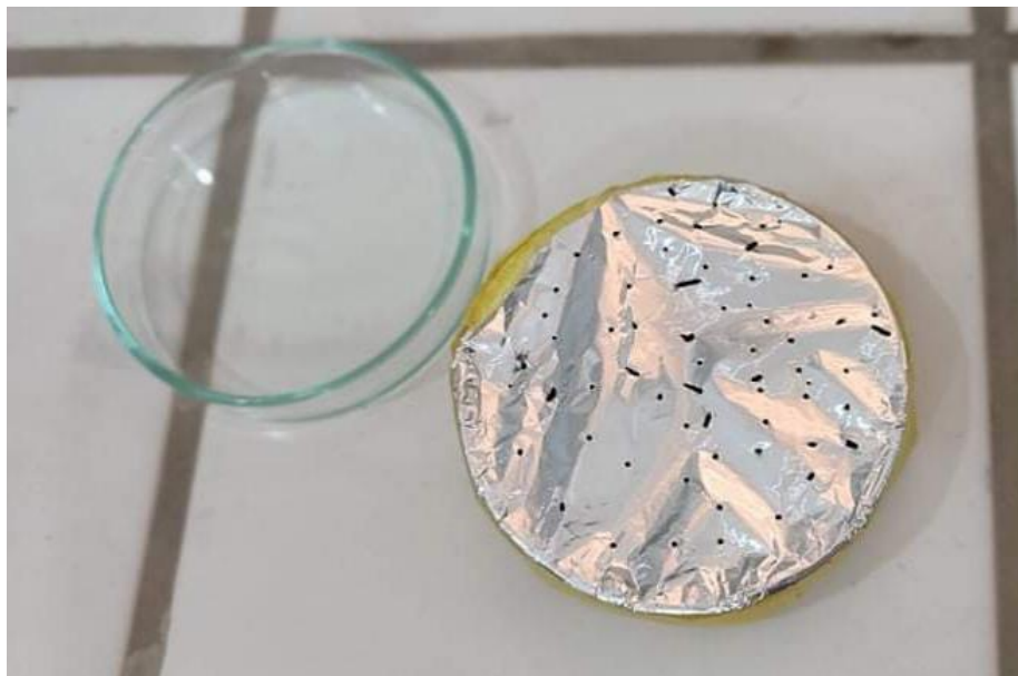
Figure 8 : Evaporation de TFA dans une boîte de pétri de petit volume sous la hotte après l'ajout de quelques gouttes de méthanol aux hydrolysats.
