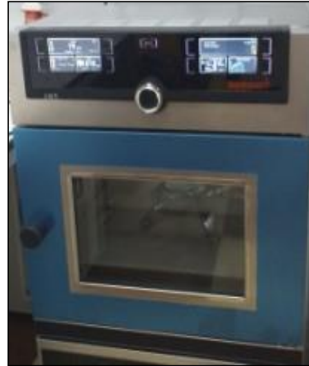
Séchée dans une étuve à 105°C
