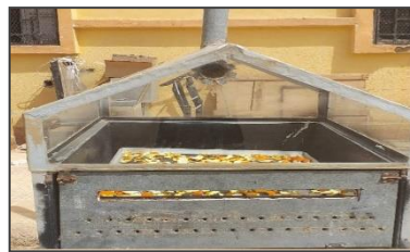
Figure 2 : le poivron vert dans séchoir solaire indirect et direct.
