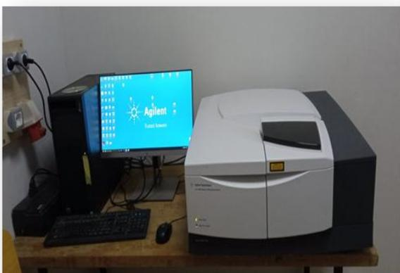
**Spectroscopie infrarouge à transformée de Fourier (FTIR)**
