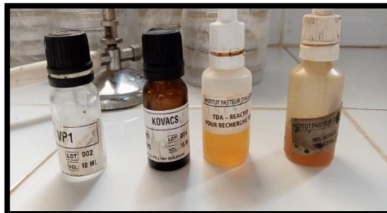
Photo 9: Les réactifs utilisés pour lecture les tests VP, TDA, IND.
