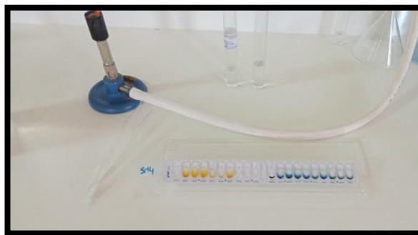
Photo 8: Introduction de la suspension bactérienne dans les tubes de galerie.
