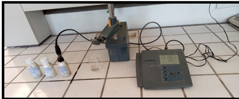
Photo 2: Mesure de la conductivité électrique de l'eau du Chott
