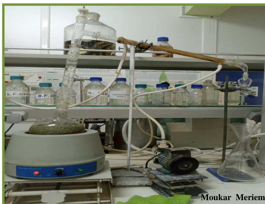
PHOTO N 0 02: Montage d'hydro-distillation de type CLEVINGER, utilisé lors d'extraction de l'HEs d'Artemisia herba alba .
