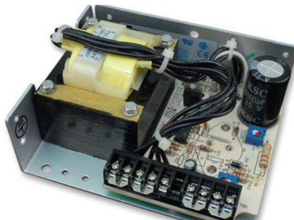
Figure I.3: Vue interne d'une alimentation linéaire.
