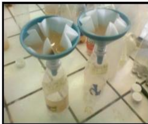
Photo 26: filtration des solutions du sol
