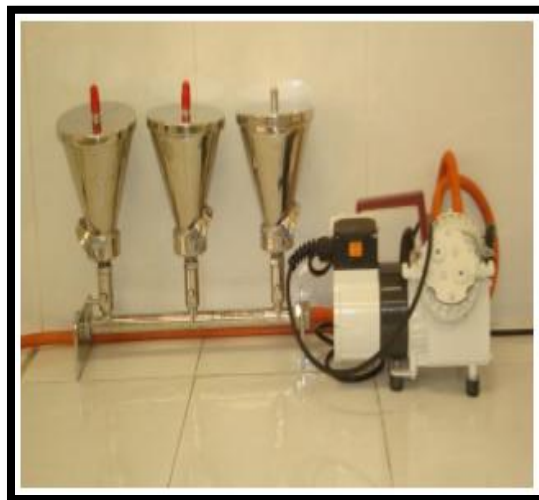
Photo 14: Pompe à vide.
