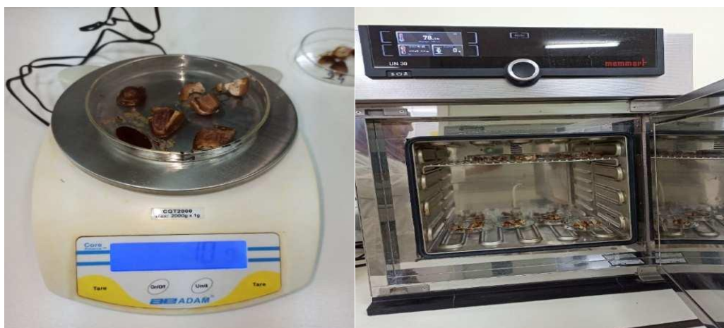
Photo 8. Détermination de la teneur en eau des dattes.
