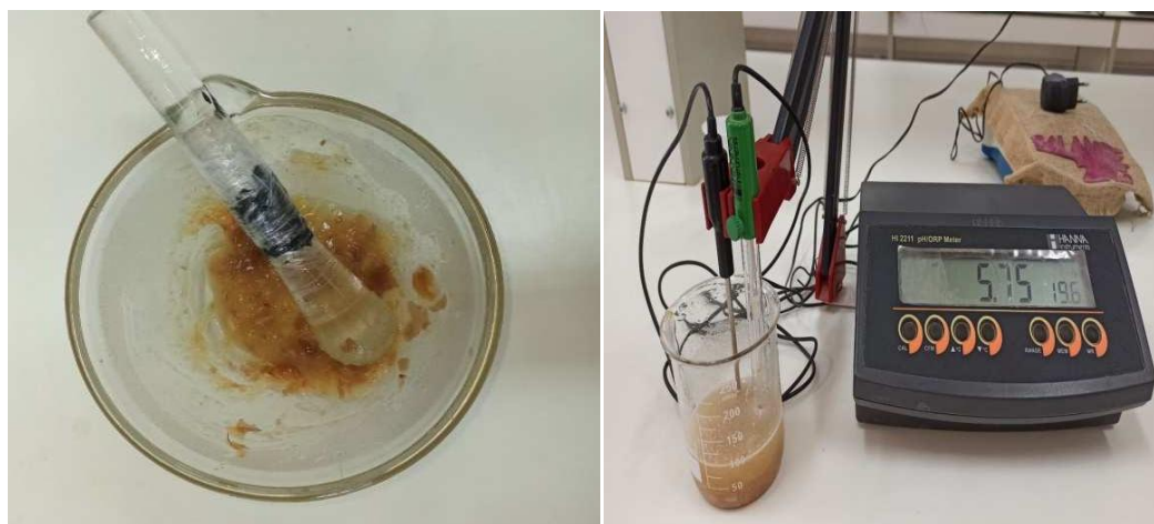
Photo 9. Broyage des dattes au mortier et mesure du Ph des dattes au pH-mètre.
