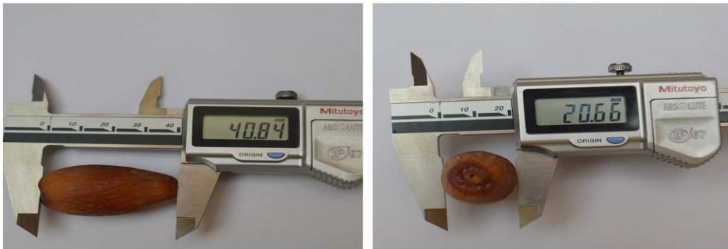
Photo6. Mesures biométrique (longueur et largeur) de datte
