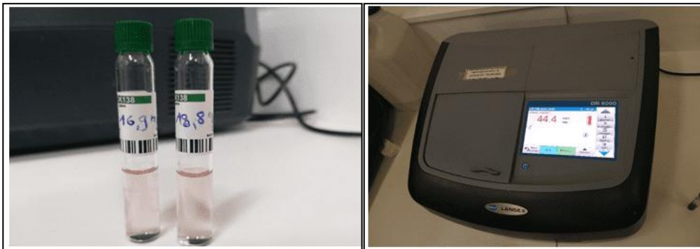
Figure N°5 : Dosage de l'azote à l'aide de spectrophotomètre de paillasse UV-VIS DR 6000
