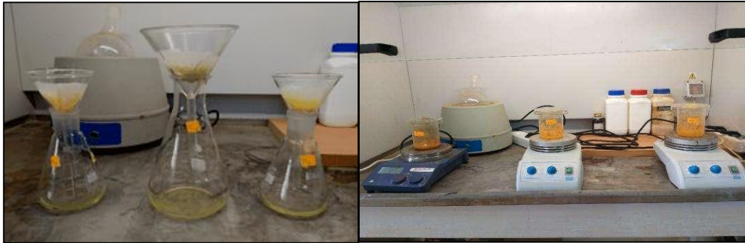
Figure N°6 : Agitation et filtration des échantillons de crottin
