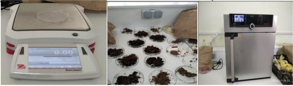
**Photo.3.** Détermination de l'humidité du terreau
