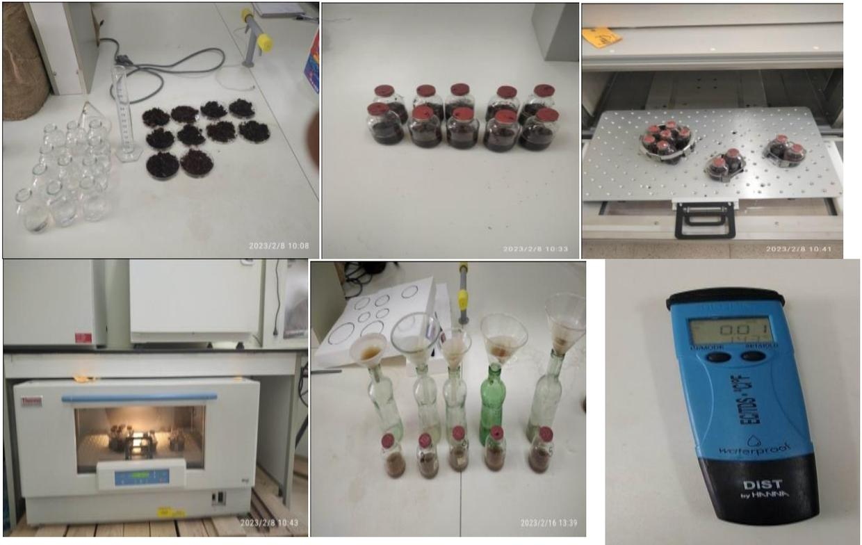
**Photo 2.** Mesure de la conductivité électrique du terreau
