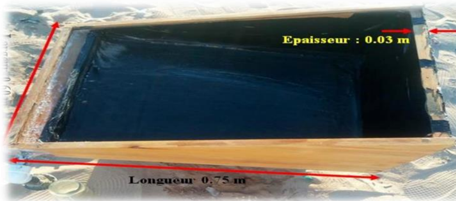
Photo 1 : Distillateur solaire à pente unique
