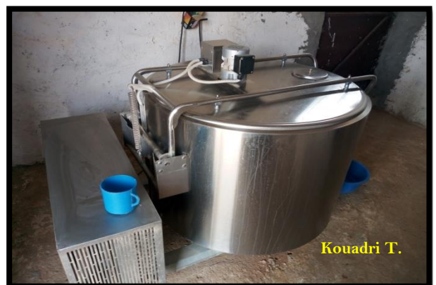
Photo N° 6: Cuve de collecte du lait, capacité de stockage 500(L), au niveau de la ferme Bouhafes.
