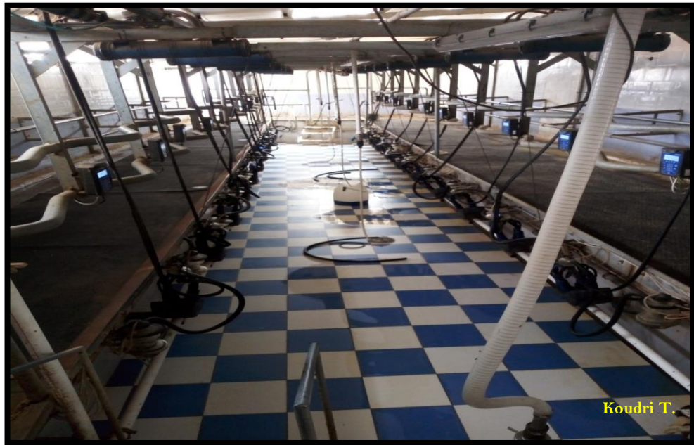
Photo N° 11: la salle de traite est sous forme épi 30° d'une capacité de 10.2 postes au niveau de la ferme ben hadide
