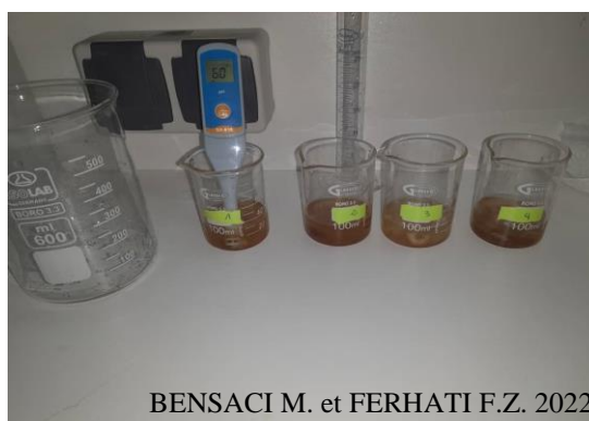
Photo 18 : Mesure du pH des dattes à l'aide de pH-mètre
