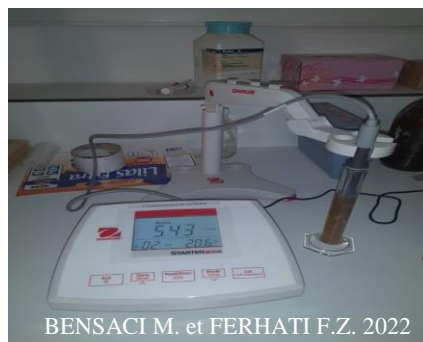
Photo 19 : Mesure de la conductivité des dattes à l'aide conductimètre
