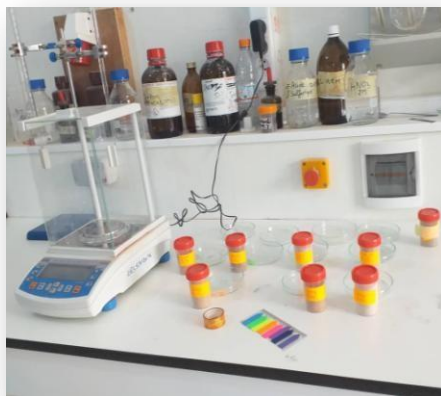
Photo IV.2 : Matériel de méthode du dosage du gypse thermogravimétrique par Artieda et al. (2006) dans le laboratoire de géologie au niveau de centre de recherche Kasdi Merbah Ouargla.
