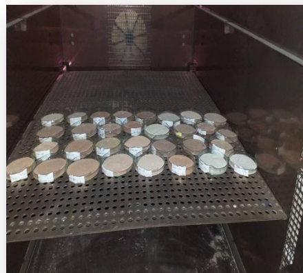
Photo IV.2 : Matériel de méthode du dosage du gypse thermogravimétrique par Artieda et al. (2006) dans le laboratoire de géologie au niveau de centre de recherche Kasdi Merbah Ouargla.
