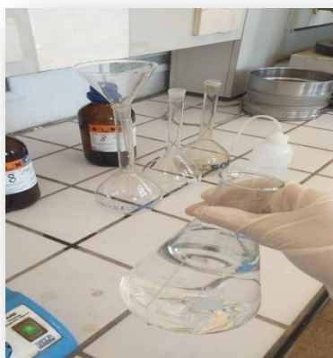
Photo IV.1: Matériel de méthode du dosage du gypse Coutinet (1965) dans le laboratoire de l'université Kasdi Merbah Ouargla (ITAS).
