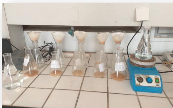
Photo IV.1: Matériel de méthode du dosage du gypse Coutinet (1965) dans le laboratoire de l'université Kasdi Merbah Ouargla (ITAS).
