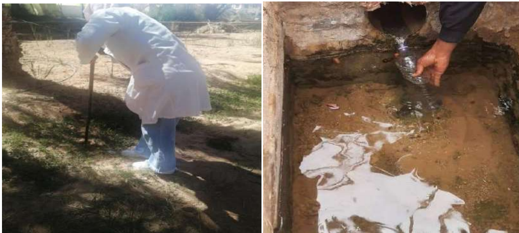
Photo 11: prélèvement des échantillons du sol et de l'eau
