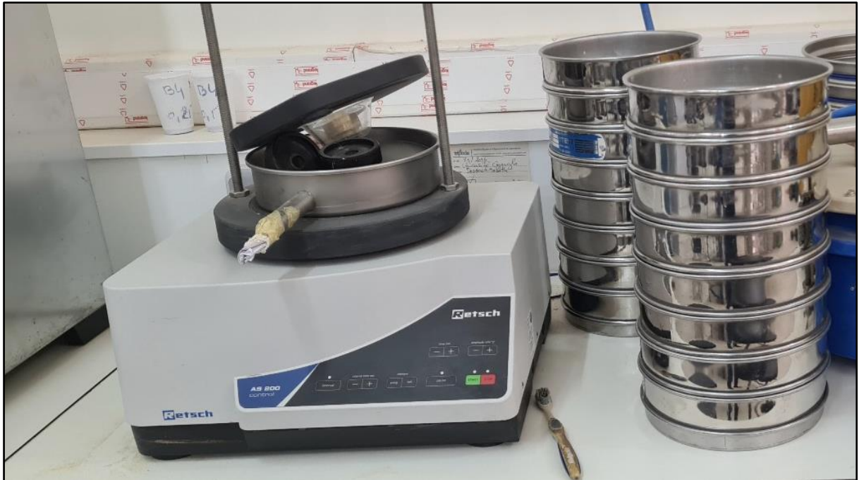
Fig. 6:Photo montrant Appareil de granulométrie (tamis avec tamiseur)
