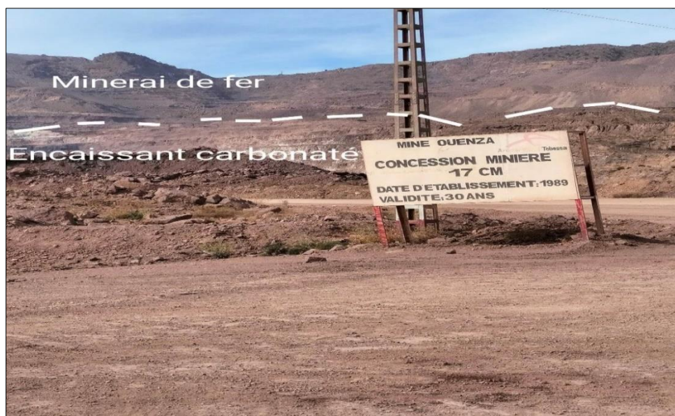
Figure 11 : Contact entre le minerai et l'encaissant carbonater.
