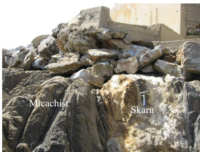
Fig. 9: photo montre un skarns très altère en contact avec les micaschistes et les cipolins.
