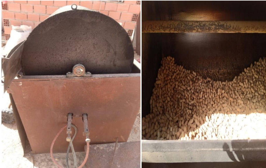
Photo 14. Machine traditionnelle pour grillage de l'arachide
