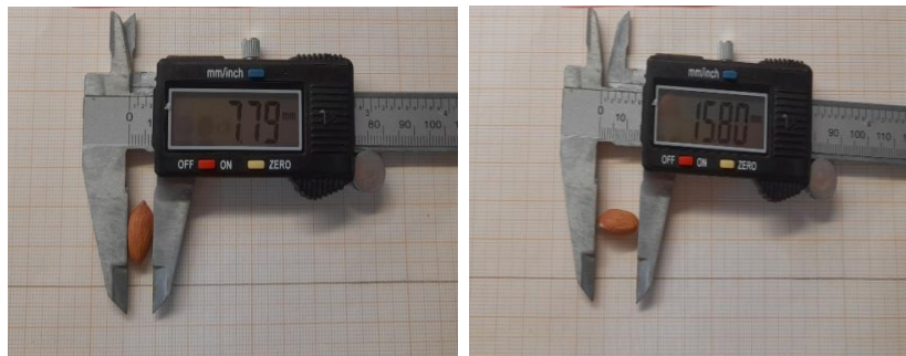
Photo 18. Mesure largeurs et longueurs des graines par pied à coulisse
