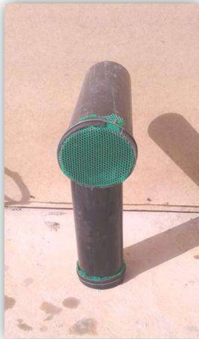
Photo 11. Un filet filtrant pour éviter le passage de sable (ZAIZ, 2020).
