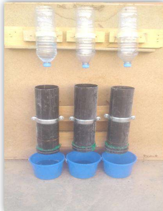
Photo 12. Dispositif expérimental (Pots de filtration avec filtres) (ZAIZ, 2020).
