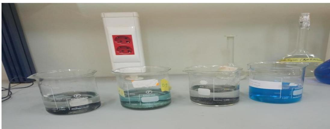
Figure 25 : changement de couleur à l'équilibre (pour  $C_0=5\text{mg/L}$  ;  $m=0.3\text{g}$ )
