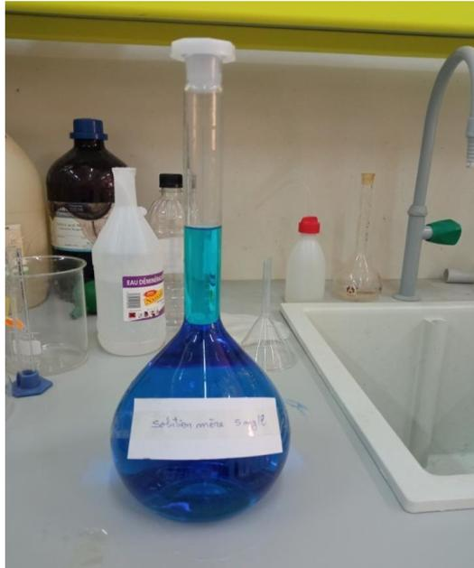
*Figure 16: solution mère de bleu méthylène 5mg/l.*
