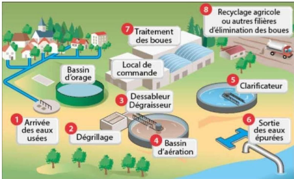
Figure 1: Schéma de fonctionnement d'une station d'épuration.
