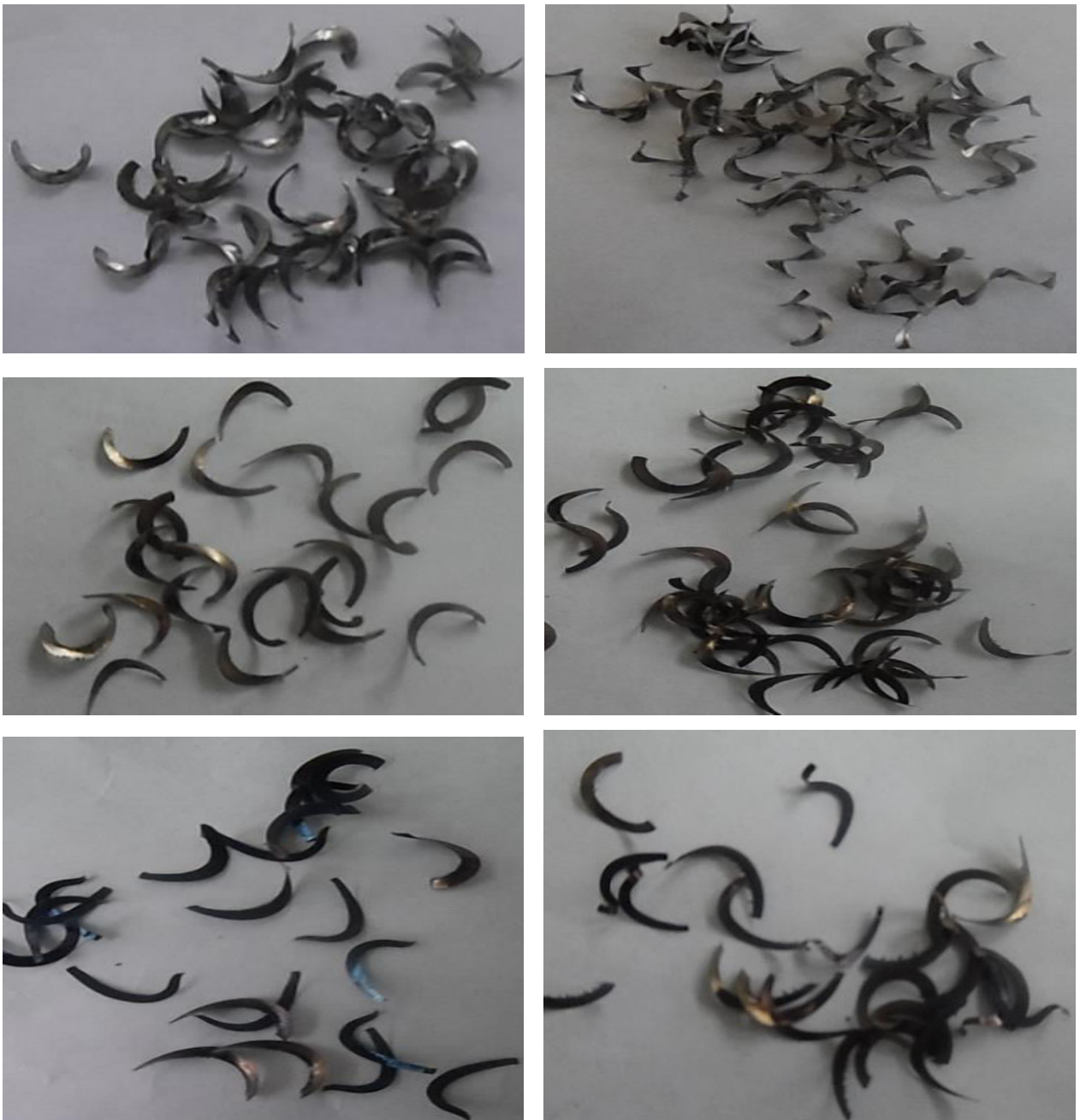
Figure III.8: les copeaux générés durant l'opération fraisage.
