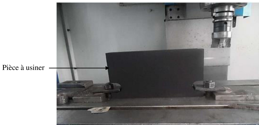
Figure II.08: Fixation de pièce sur la table de travail.
