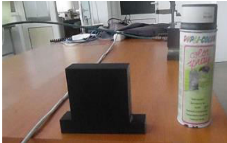
Figure II.11: Peinture noire mate est appliquée à une zone de la surface de la pièce.
