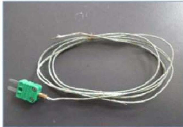
*Figure II.7* Thermocouple de type K.
