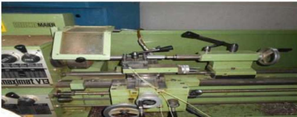
*Figure II.10 Dispositif de fixation de la pièce*
