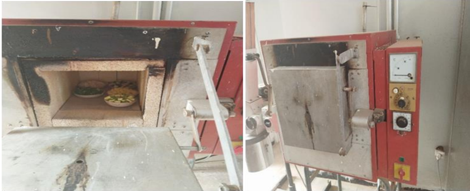
Figure 15. Calcination des légumes dans un four à 500 °C
