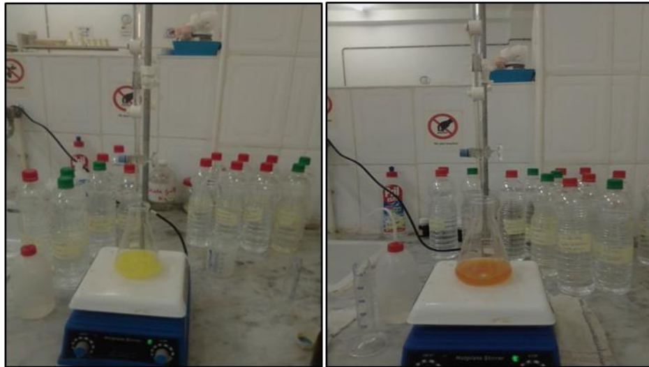
Figure 11. Dosage des ions chlorures par la méthode de Mohr
